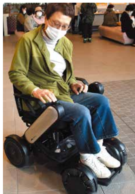
↑未来感あふれる電動車いす「ウィル」。右アームの先のコントローラーを傾けると前後左右に動く。高さ5センチの段差も乗り越え、芝生の上でもOK
