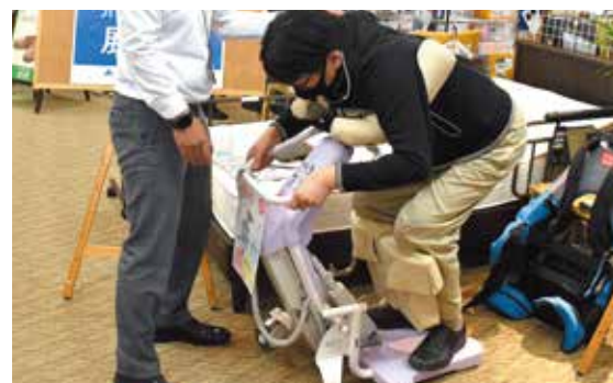
↑ベッドから車いすなどへの乗り移りをサポートするロボット「ハグ」
