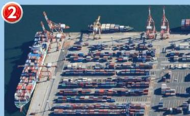
**2 コンテナふ頭** コンテナ船が着き、ガントリークレーンでコンテナの積みおろしをします。コンテナを保管したり、コンテナを運ぶトレーラーと受けわたす場所をコンテナヤードといいます。
