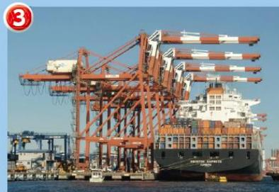
**3 ガントリークレーン** 車輪がついている橋の形をしたクレーンで地上のレールの上を動き、船からコンテナをおろしたり、積んだりします。大きなものは100m以上の高さがあります。
